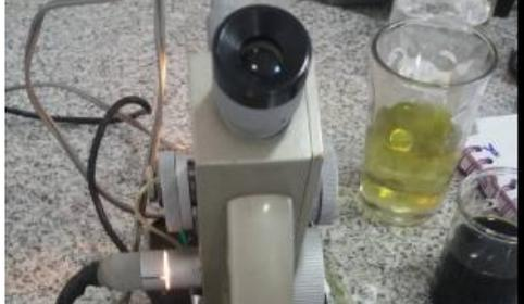
Determinación del índice de refracción
