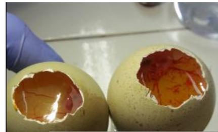
De Izquierda a derecha control negativo y control positivo HET-CAM
