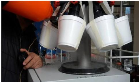
Liofilización y obtención del extracto seco
