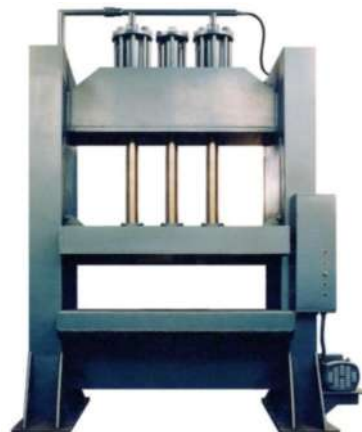
Figura 3-1. Compactadora Hidráulica Manual
