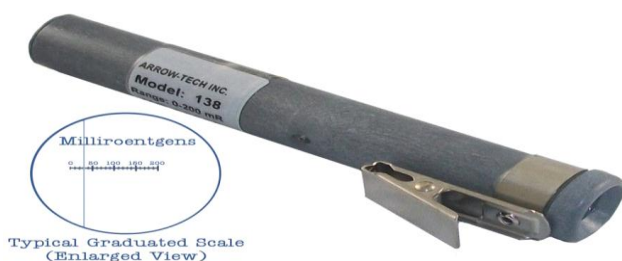
Figura 10-1: Dosímetro de tipo lapicero. Realizado por: Gonzáles, 2010.
