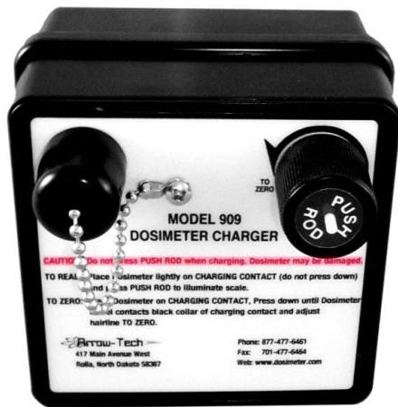
Figura 11-1: Carga y ajuste a cero del dosímetro al colocarlo sobre el socket de carga. Realizado por: Gonzáles, 2010.
