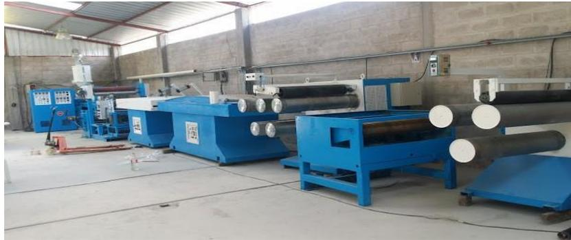
**Figura 10-2:** Línea de extrusión de la empresa HIPLAS
