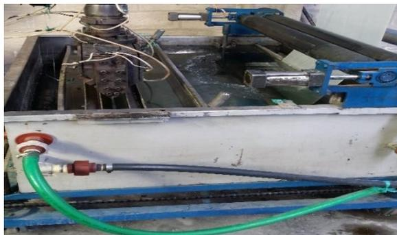
**Figura 14-2:** Tanque de enfriamiento
