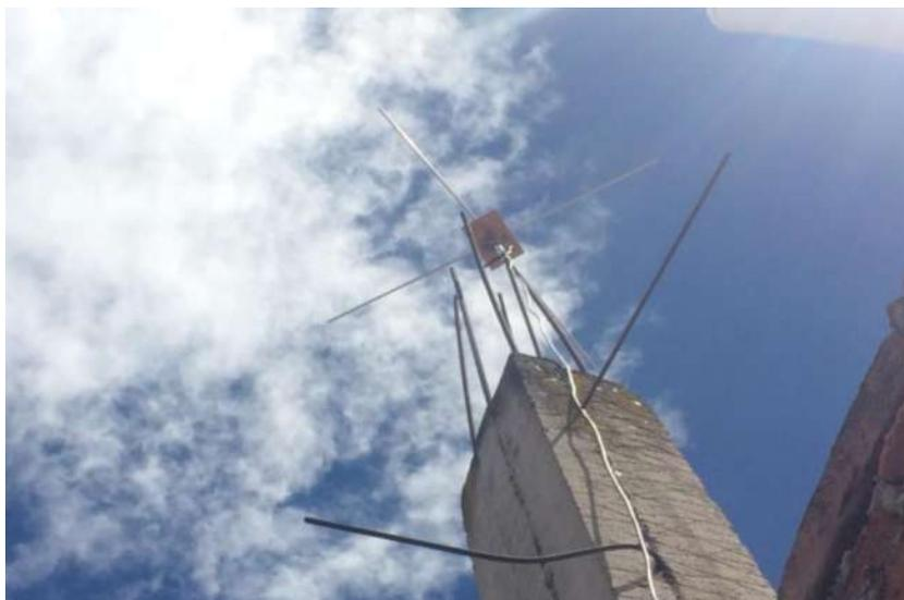
**Figura 12-2:** Antena Turnstile finalizada
