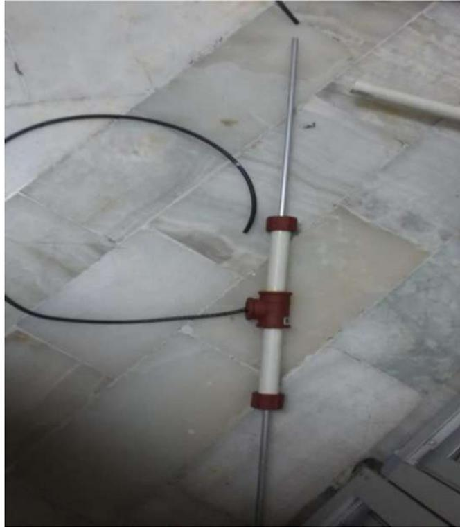
**Unión de los dipolos con los tubos de PVC**
