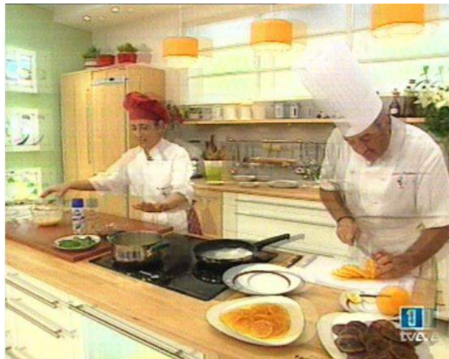
Figura 12-1: Doble imagen en recepción de televisión analógica
