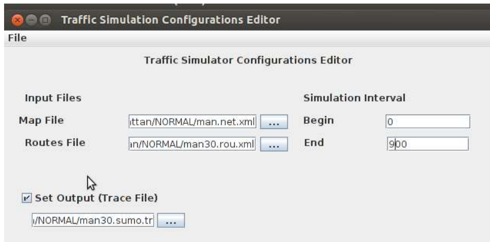
Figura 12-B: Creación de los archivo .sumo.tr y .sumo.cfg (Manhattan)
