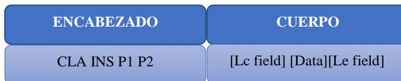
**Figura 16-1** Estructura de la APDU de comando
