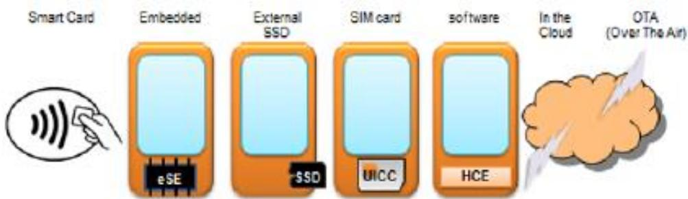
**Figura 5-1** Configuraciones del Elemento Seguro
