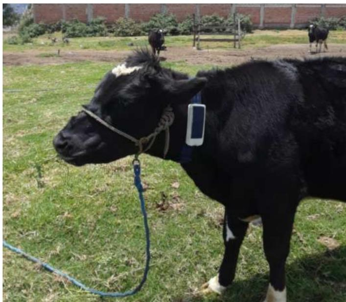
**Figura 1-3:** Prototipo de collar implementado en el semoviente.
