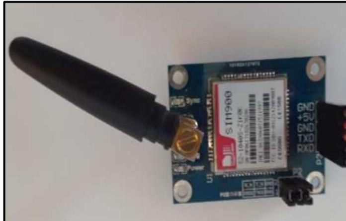
**Figura 10-2:** Módulo SIM900 (GSM/GPRS)
