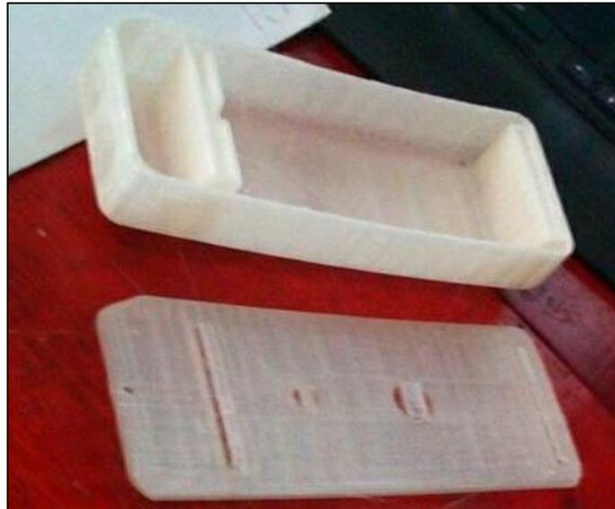
**Figura 22-2:** Estructura impresa en 3D.
