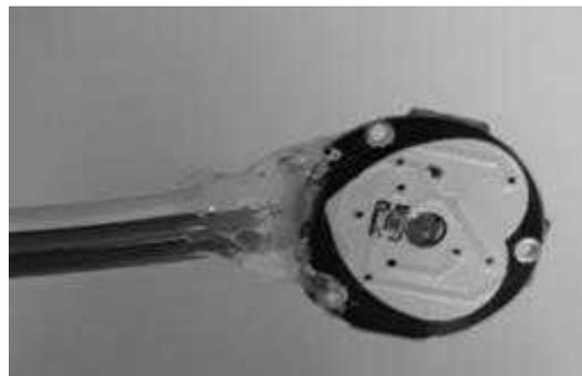
**Figura 6-2:** Sensor de pulsos cardíaco
