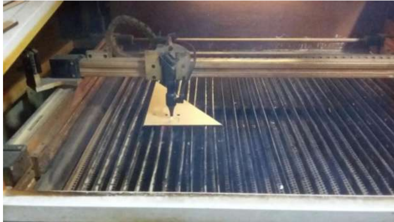
Figura 22 - 2: Corte de la Carcasa Fuente: REDROBÁN, Laura, 2018
