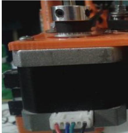
**Figura 20-1:** Motor pasó a paso Nema 17
