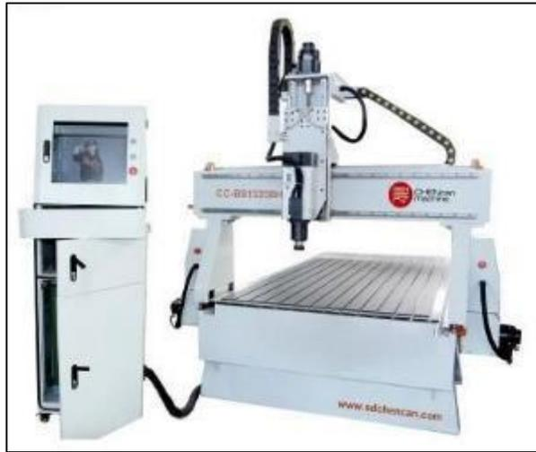
**Figura 15-1:** Máquina CNC para moldes en madera.
