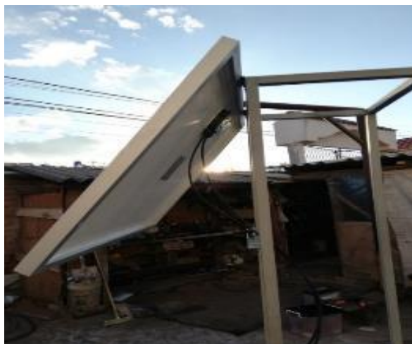
Figura 7-3: Inclinación del panel a 45 grados
