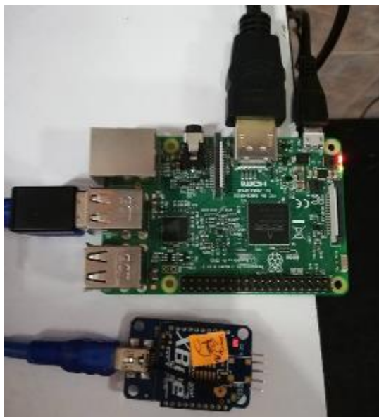
Figura 31-2: Conexión Raspberry - Xbee receptor
