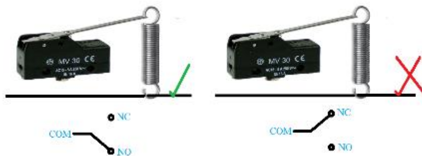
Figura 16-2: Estado de sensor según el estado del alambre del cerco
