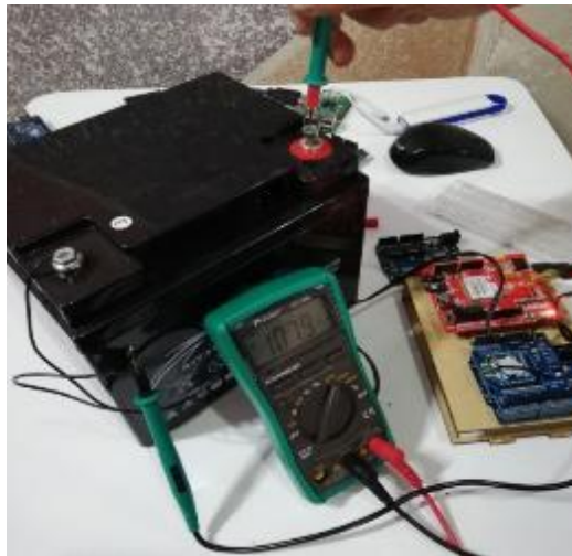
Figura 5-3.: Consumo amperaje del Arduino UNO – SIM900A
