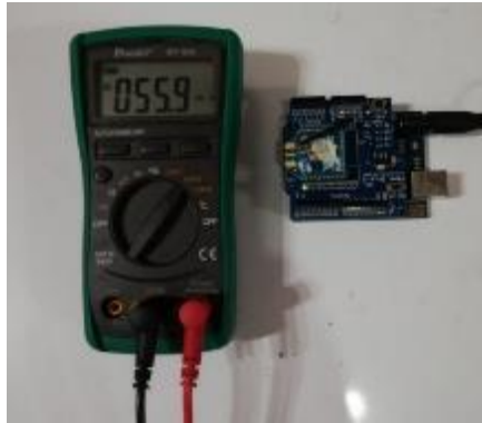
Figura 4-3: Consumo amperaje del Arduino UNO – Xbee S2
