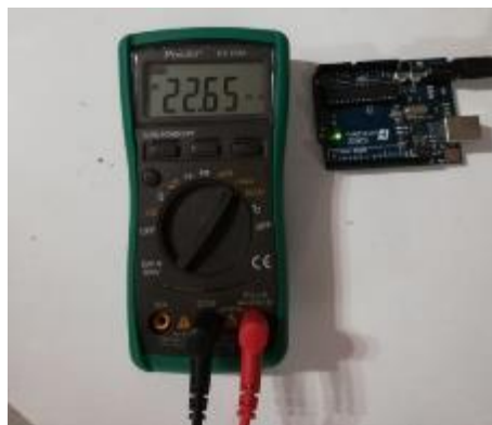
Figura 3-3: Consumo amperaje del Arduino UNO
