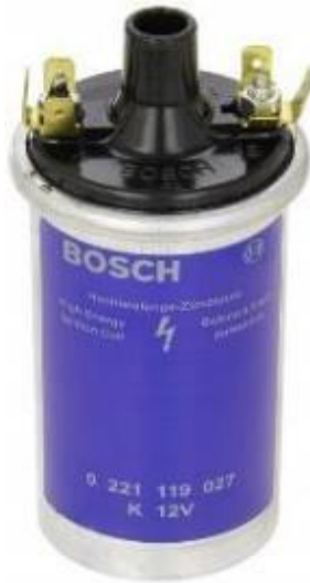
Figura 6-2: Bobina de arranque de un vehículo
