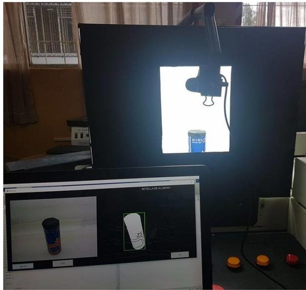
**Figura 85-3.** Procesamiento y clasificación de botellas de aluminio
