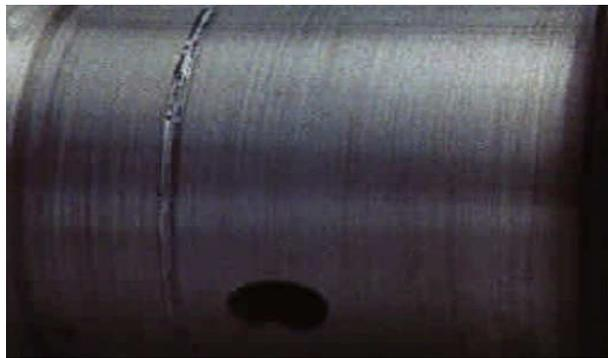
**Figura 2.6:** Rayaduras en los Codos del Cigüeñal Causado por los Abrasivos en la Superficie del Cojinete
