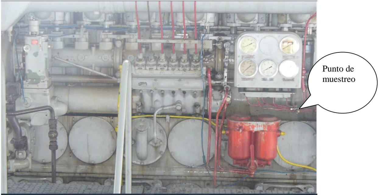
**Figura 3.1:** Determinación del Punto de Muestreo en el Motor
