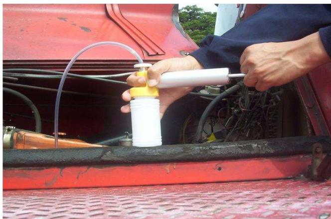
**Figura 2.9:** Método de la Pistola de Muestreo
