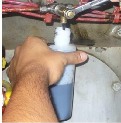
**Figura 3.4:** Recolección del Aceite Usado a Analizarse
