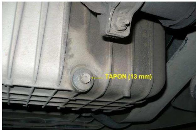
**Figura 2.8:** Método del Tapón de Drenaje
