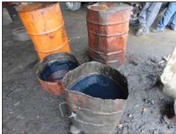
Figura 3.33: Tanques Deteriorados que son Usados como Depósitos de Aceites Usados.
