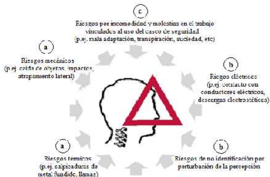
Figura 5.37: Riesgos a los que Está Expuesto el Cráneo del Trabajador.
