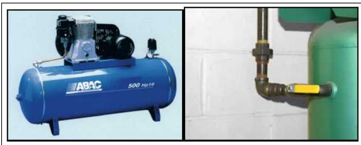
Figura 2.16: Depósitos o Calderines de Aire Comprimido.
