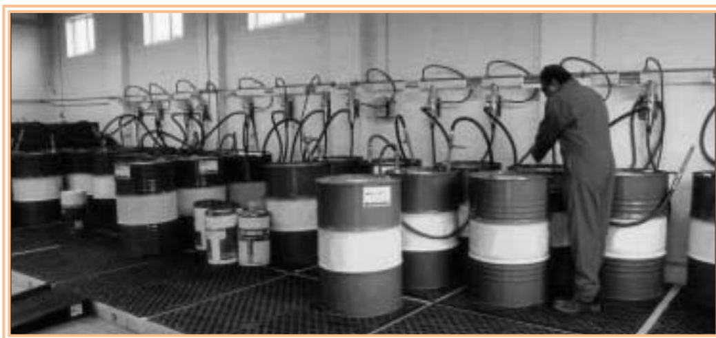
Figura 2.12: Ejemplo de buena práctica en un almacén de aceite; la imagen muestra un sistema de plataformas con muros de contención y rampas de acceso.
