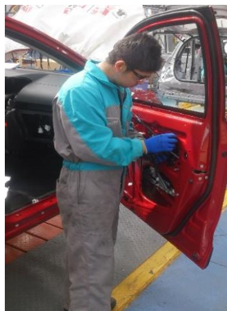
Figura 10-3: Instalación de componentes de las ventanas.
