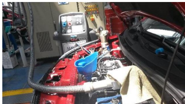
Figura 14-3: Llenado del líquido de frenos y de dirección.
