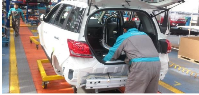
Figura 11-3: Instalación de asientos y espaldares.
