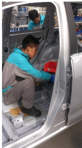
Figura 8-3: Preparación de la cabina en la línea de ensamble TRIM.
