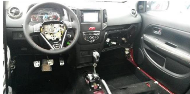
Figura 13-3: Instalación de la consola central.
