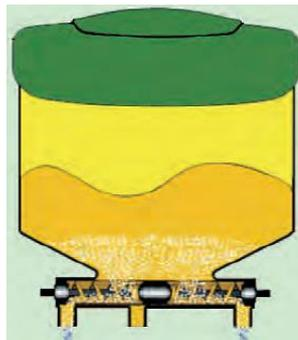
**Figura 23-2:** Mecanismo por tornillo sin fin
