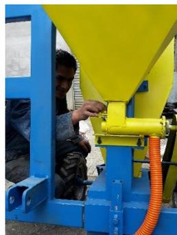
**Figura 7-6:** Regulación de fertilizante
