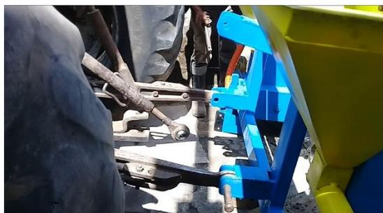
**Figura 10-6:** Desenganche de la máquina
