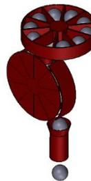
**Figura 18-3:** De alveolos horizontales con rueda de alveolos vertical
