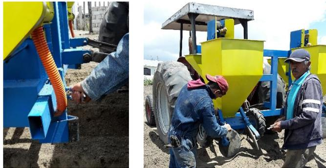
**Figura 5-6:** Regulación del surcador y tapador
