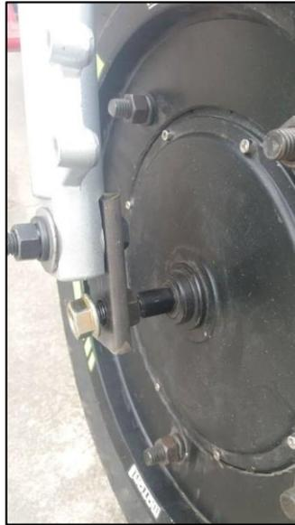
**Figura 7-4:** Adaptación de platinas al eje y brazos de la suspensión delantera.
