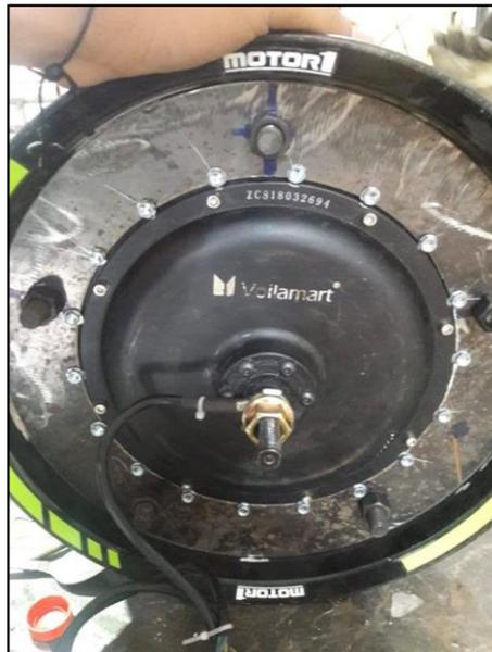
**Figura 6-4:** Acople de discos de acero al rin y motor eléctrico.
