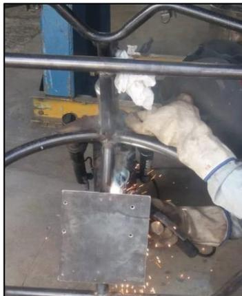
**Figura 10-4:** Soldadura de la placa porta batería y controlador en el bastidor.
