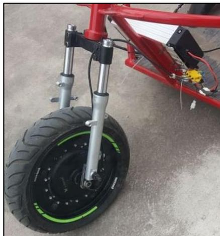
**Figura 8-4:** Montaje de platinas en el motor, y brazos de la suspensión.
