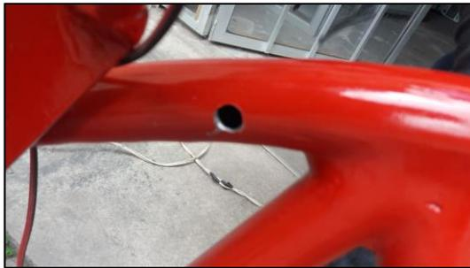
**Figura 14-4:** Orificios de 3/8 en la estructura mediante el uso de taladro.
