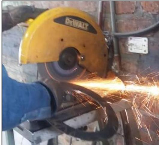
**Figura 4-4:** Eliminando irregularidades de corte con la ayuda de una pulidora
