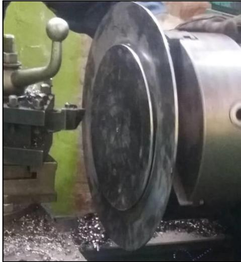
**Figura 3-4:** Disco de acero ASTM36.
