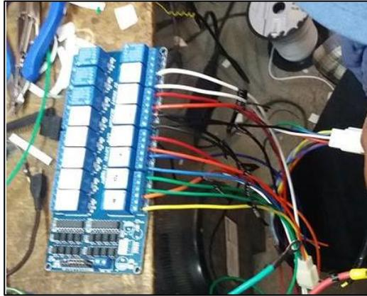
**Figura 13-4:** Conexión del módulo relé.
