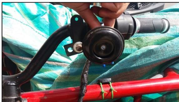
**Figura 17-4:** Instalación del claxon.
