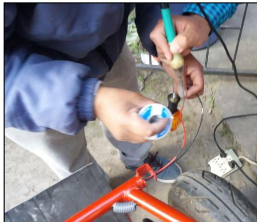
**Figura 16-4:** Instalación de luces direccionales.
