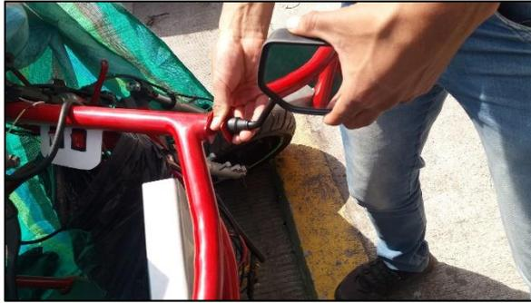
**Figura 18-4:** Instalación de retrovisores.
